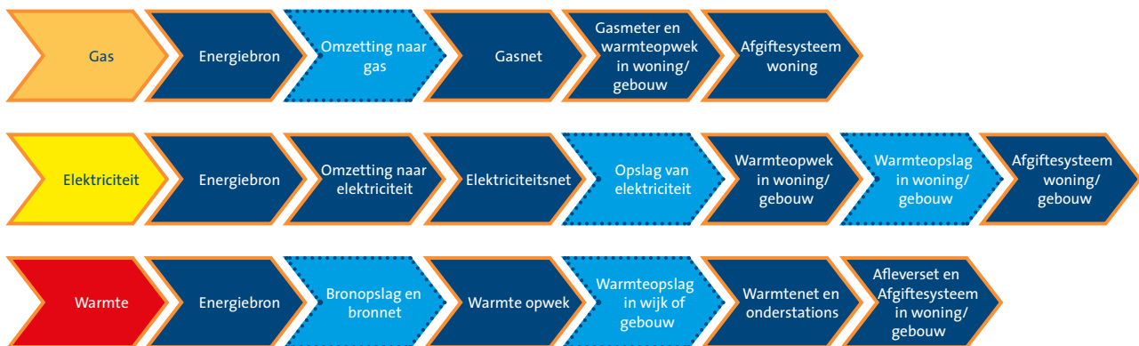
Figuur 2.1: Warmteketen voor een gasnet, all electric en een warmtenet.
